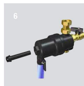
6 Po kilku sekundach otwórz minimalnie zawór odcinający aby wypłukać wnętrze urządzenia
